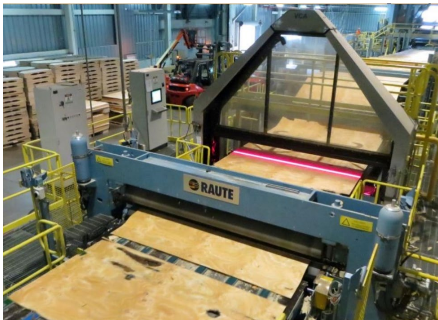
Joonis 2.75 Spooni defektide automaatne tuvastamine ja spooni formaati lõikamine. Foto: Raute OYj
