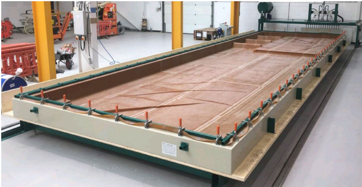
Joonis 5.17 Ristkihtliimpuidu vaakumpress. Foto: hoechsmann.com
