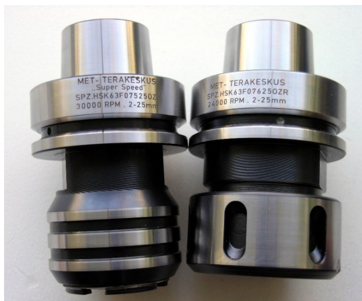
Joonis 1.66 Sisemutriga (vasakul) ja välise pingutusmutriga (paremal) tsangpadrunid. Foto: J. Ingelman
