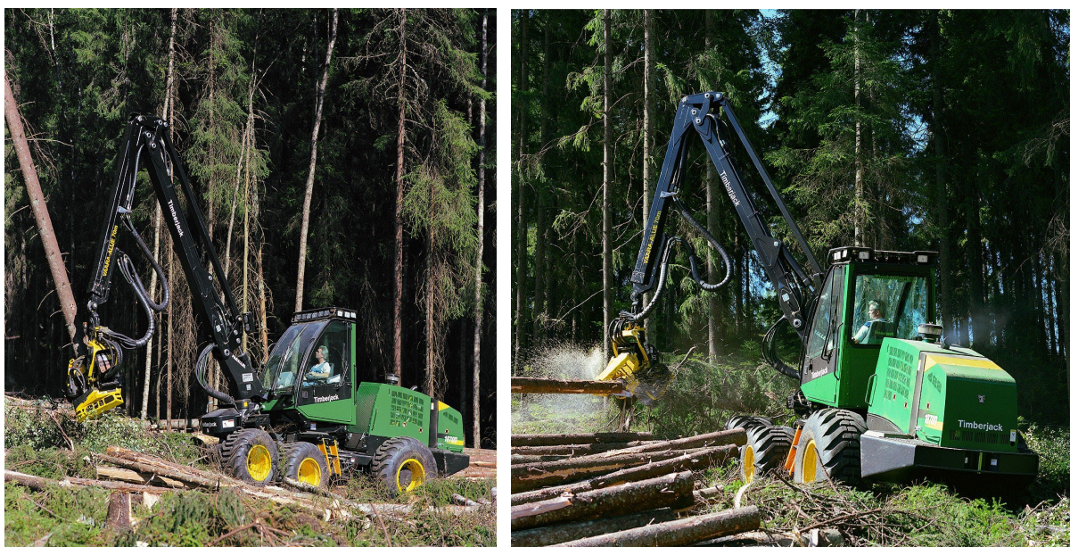
Joonis 10.52 Harvester metsas puid langetamas ja tüvesid palgi sortimentideks järkamas.
