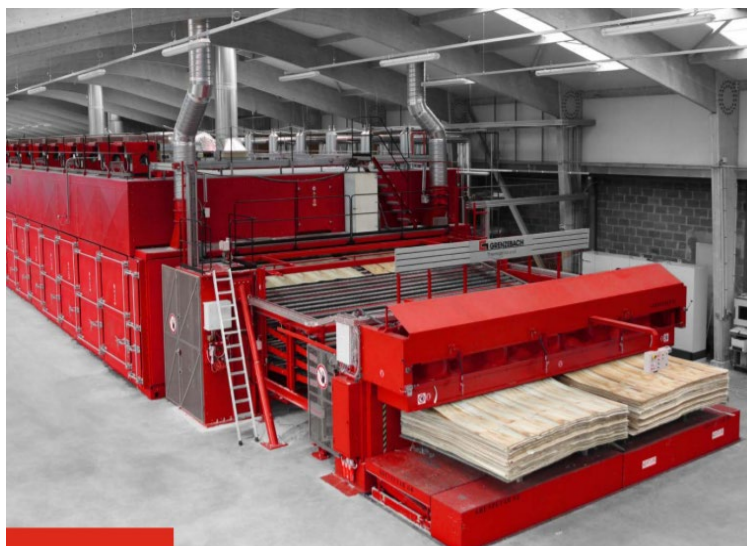
Joonis 3.37 Rullkuivatusliini automaatne spooni etteandeseade. Allikas: Grenzebach Maschinenbau GmbH
