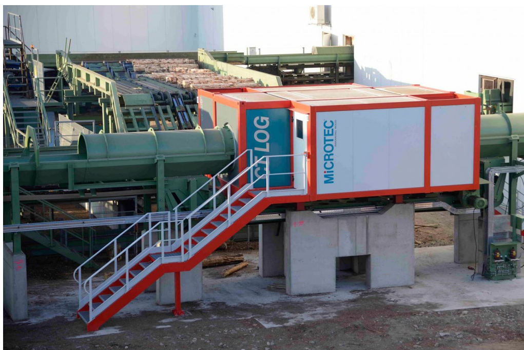
Joonis 2.4 Palgiskanner CT Log. Foto: Microtec Srl
