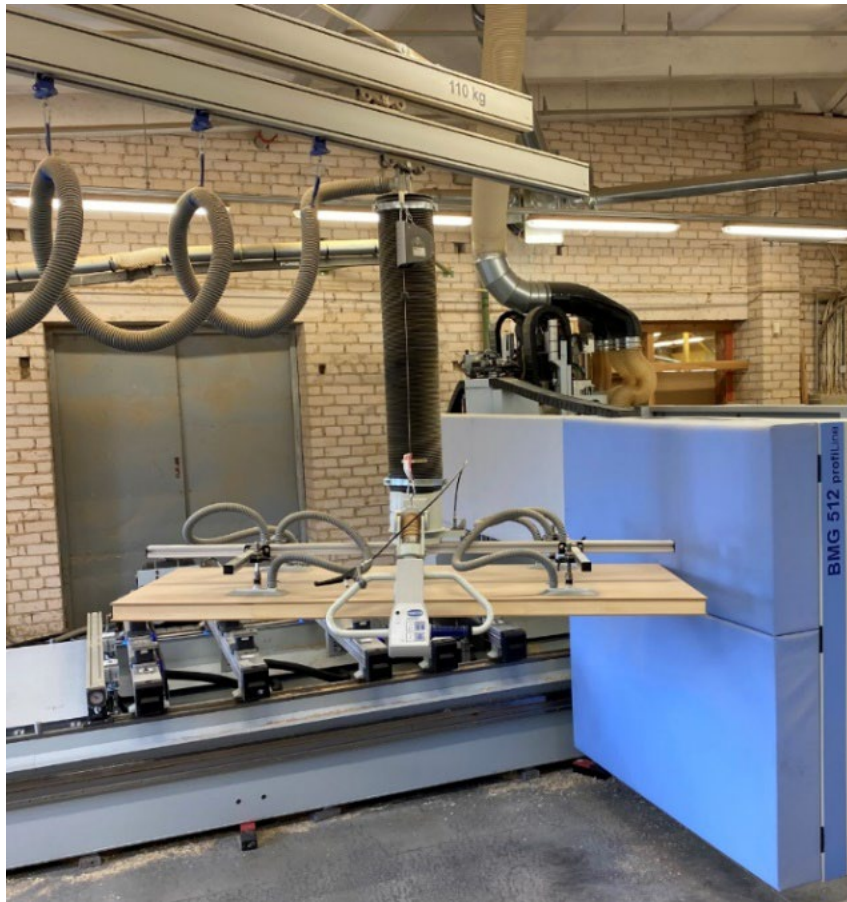
Joonis 7.49 Manuaalne teleskoopilise mastiga vaakumtõstuk.
