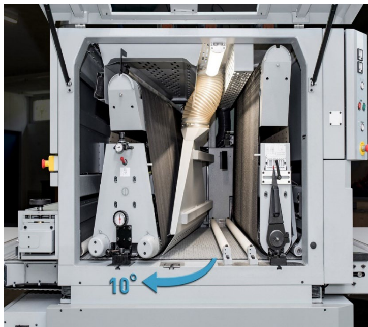
Joonis 1.100 Kontaktvaltsi ja surveelemendiga lailintlihvping (survelement on etteande suhtes ristasendist pööratud). Foto: Kündig AG
