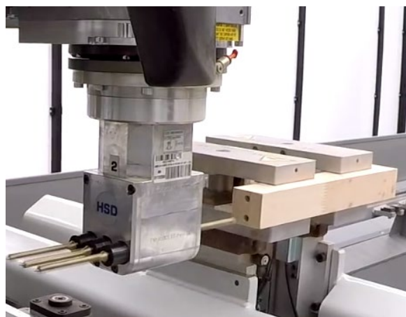
Joonis 7.61 Tüübliavade puurimine otpindadesse.
