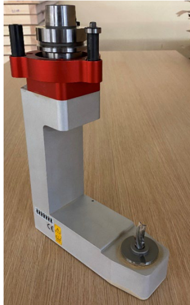
Joonis 7.43 Alttöötlus-agregaat 125 mm õlaga.
