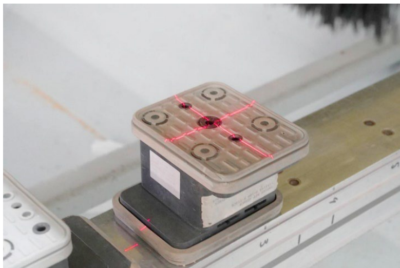
Joonis 7.9 Laserpositsioneerimisabi. Foto: Höchsmann GmbH
