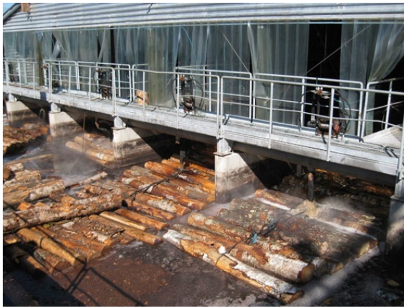
Joonis 2.57 Palkide vihmutamine ujupalkidega basseinis. Foto: Raute OYj
