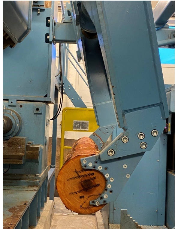
Joonis 2.68 Paku tõstmine etteandekäppadega treipingi spindlite vahele.
