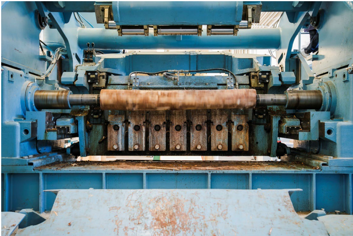
Joonis 2.66 Vineeritööstuses kasutatav spoonitreibink: pakk pöörleb spindlite vahel.
