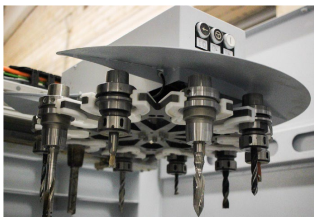
Joonis 7.35 10-kohaline tööriistakarusel erinevate puuride ja sõrmfreesidega.
