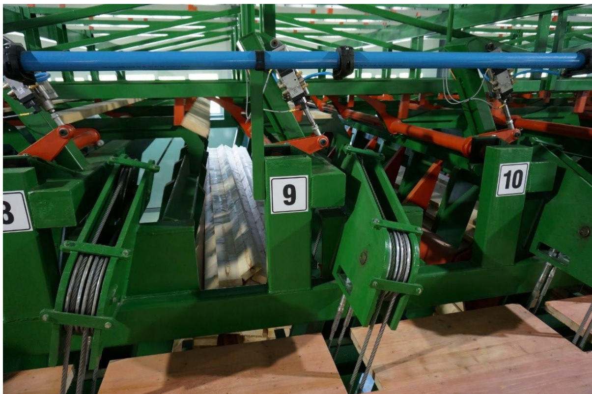
Joonis 2.26 Materjali suunamine vertikaaltaskusse. Foto: AS Hekotek
