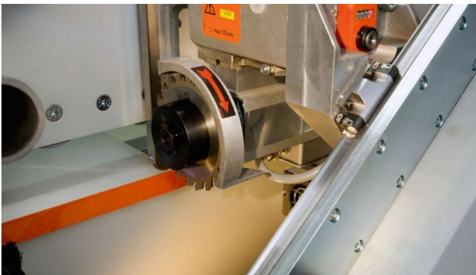
Joonis 6.17 Servapealustusmaterjali pikkuse ülemõõdu eemaldamine otsalõikesaega. Foto: HOLZ- HER GmbH
