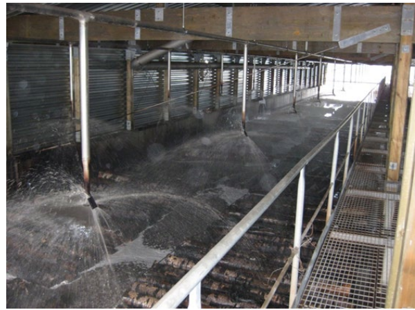
Joonis 2.57 Palkide vihmutamine ujupalkidega basseinis. Foto: Raute OYj
