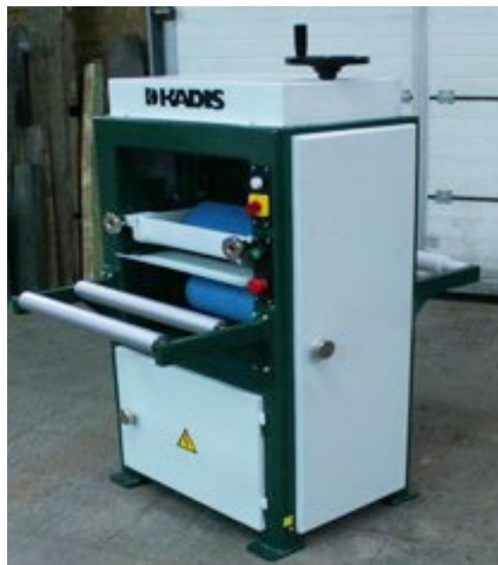
Joonis 5.13 Kahevaltsiline liimitamismasin. Foto: Kadis UAB
