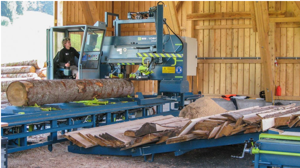
Joonis 2.47 Horisontaalne palgilintsaag. Foto: Resch & 3 GmbH
