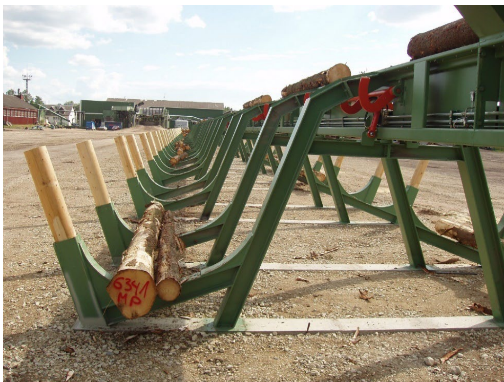
Joonis 2.3 Sorteerimistaskud. Foto: AS Hekotek
