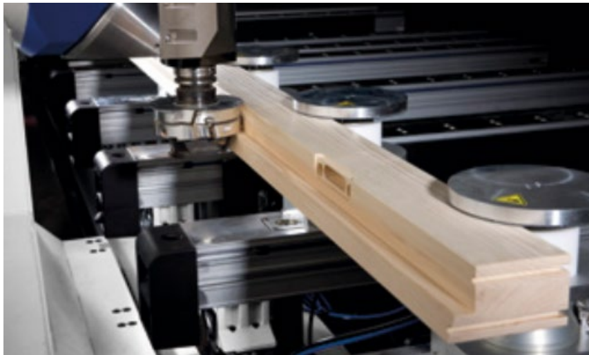
Joonis 7.39 Suruõhuklambrid raamukse detaili profileerimisel.
