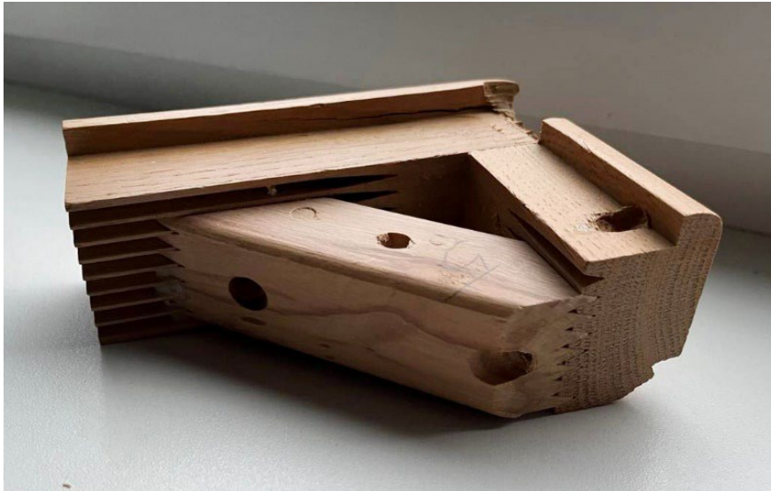
Joonis 4.32 Sõrmjätku kasutamine nurkliites puittoolide konstruktsioonis.
