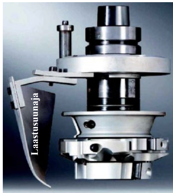
Joonis 7.34 Kombiprofiiltera vahetatavate plaatide ja laastusuunajaga.
