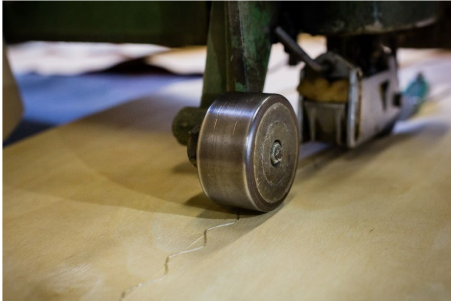
Joonis 6.30 Spooniribade ühendamine siksak-meetodil. Foto: Tarmeko AS
