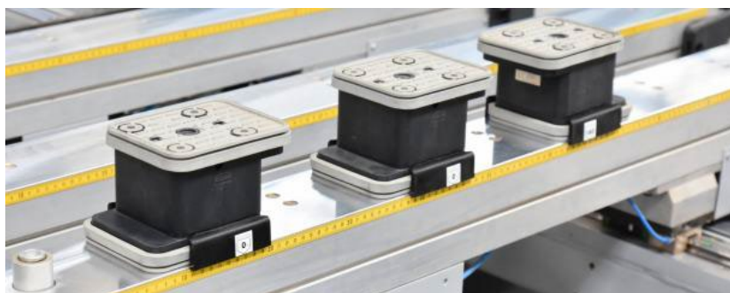
Joonis 7.8 Vaakumpatjade positsioneerimine joonlaua järgi. Foto: Höchsmann GmbH
