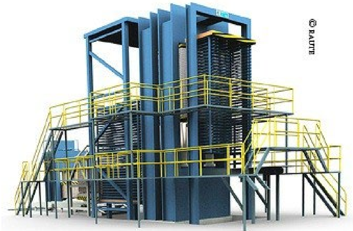
Joonis 5.76 Vineeri pressimine mitmekorruselises kuumpressis. Allikas: Raute Oyj
