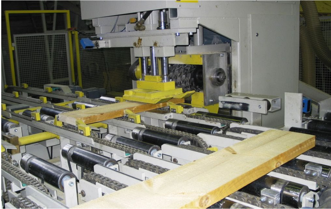
Joonis 4.24 Vertikaalse sõrmtapi freesimine. Foto: M. Riistop
