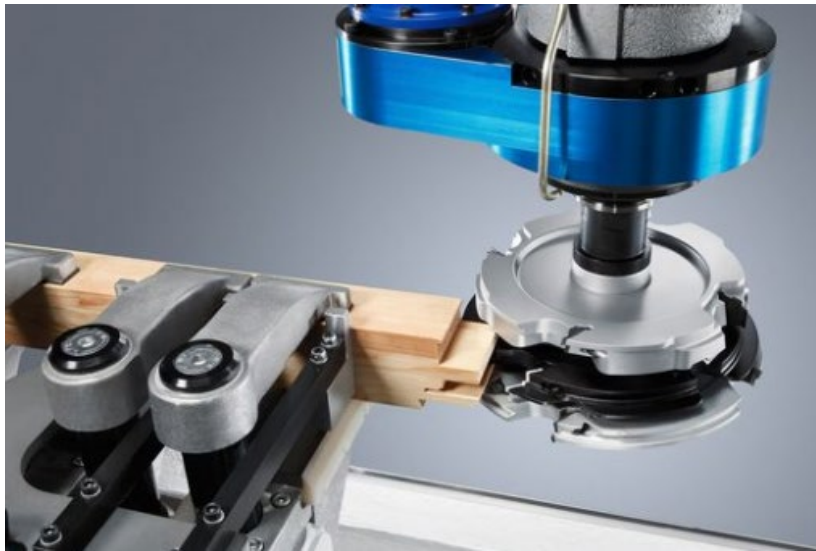
Joonis 7.52 Klassikalise tappühenduse töötlemine.
