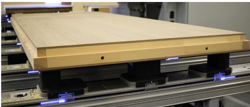
Joonis 7.38 Vaakumtald koos konsoolil olevate LED-tuledega (markeerivad sobiva koha, mis oleks lõiketsoonist eemal).
