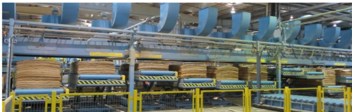
Joonis 5.45 Spooni sortimise laadimiskeskus. Allikas: Raute Oyj
