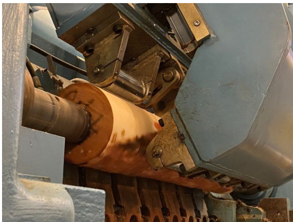
Joonis 2.69 Paku ümardamine enne treimist.
