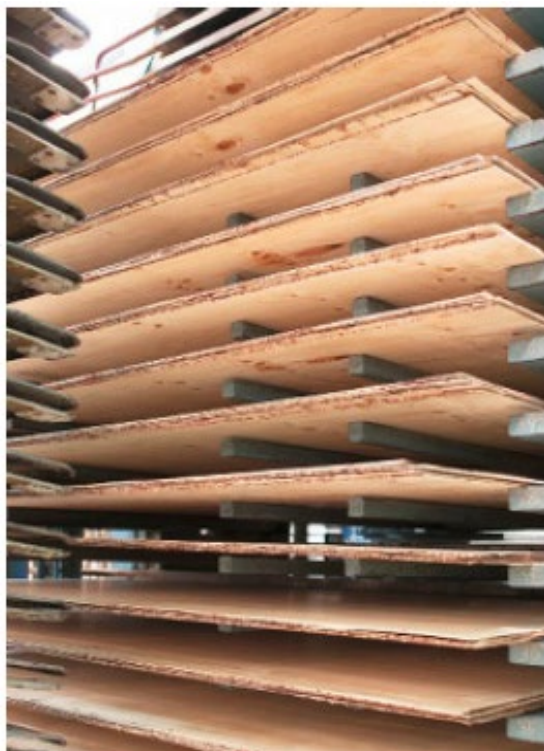
Joonis 5.78 Valmispressitud vineerplaadid kuumpressis.
