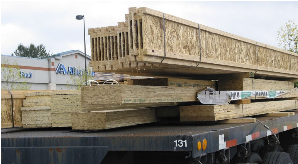
Joonis 5.33 Parallam™ vöödega kergtalad (ülal). Foto: M. Riistop
