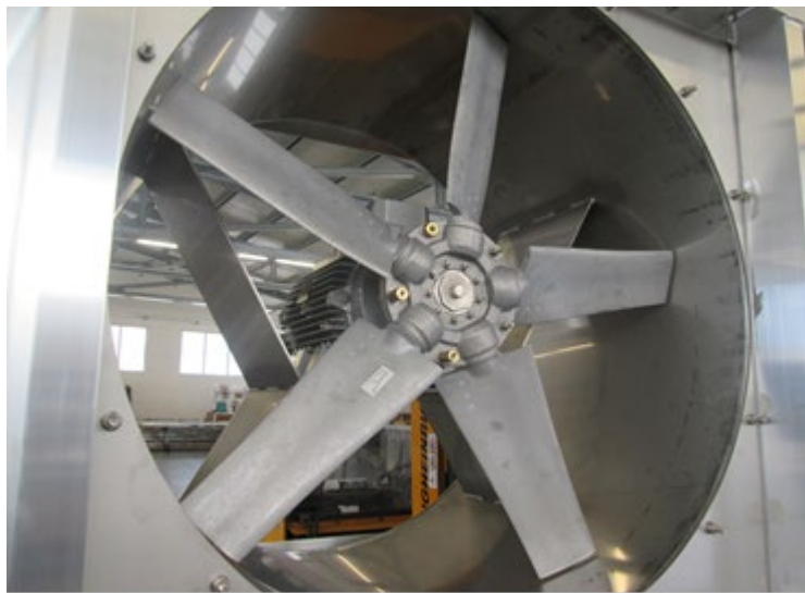
Joonis 3.7 Telgventilaator. Allikas: Termolegno S.R.L.
