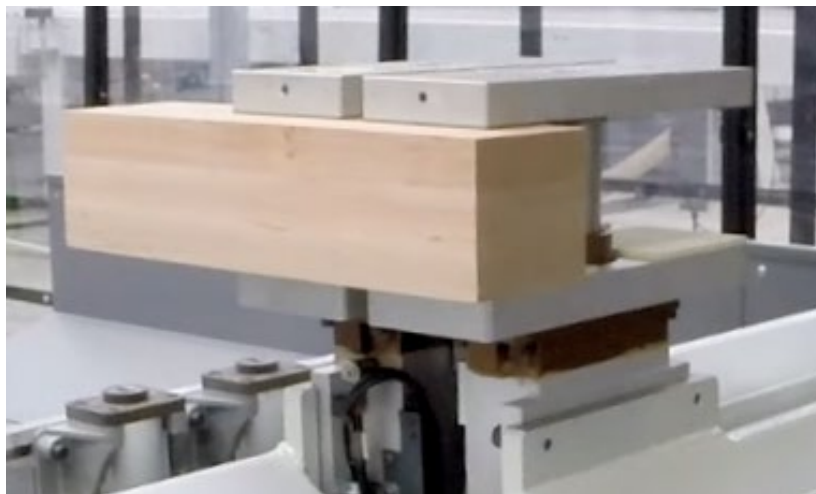
Joonis 7.53 Lühikese detaili fikseerimine kahe klambriga.
