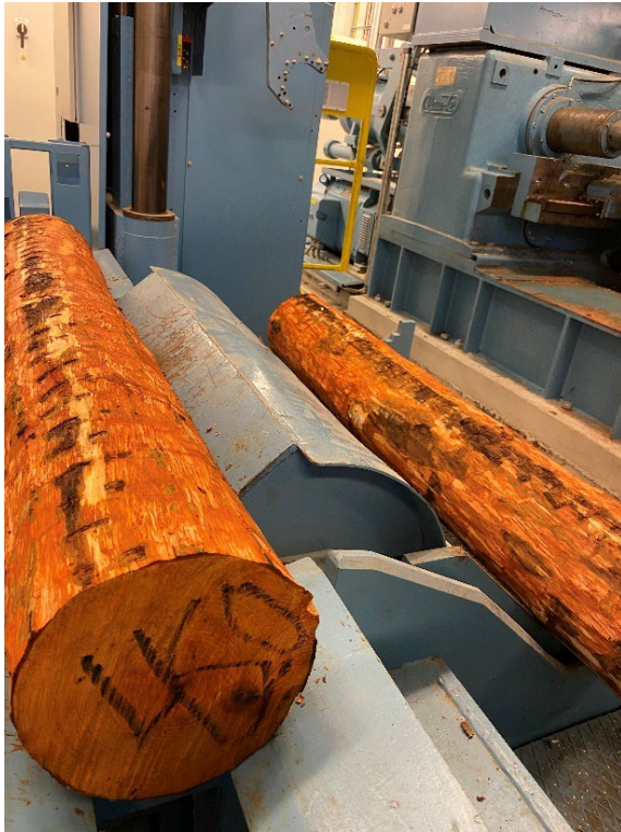
Joonis 2.67 Kooritud pakkude liikumine spoonitreipinki.
