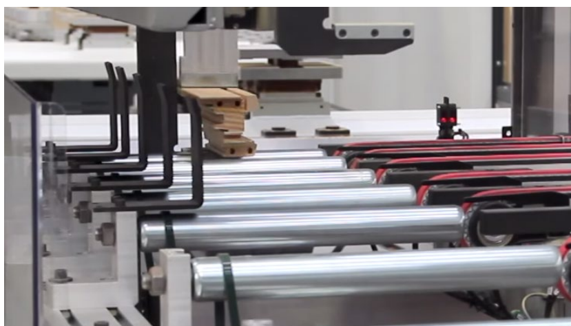
Joonis 7.67 Detaili väljalaadimine konveierile.
