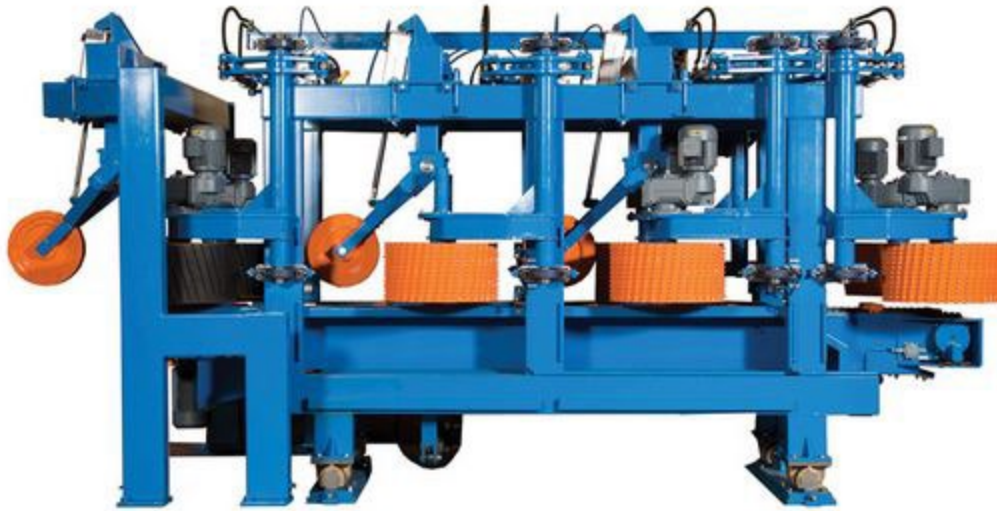
Joonis 2.32 Seade palkide positioneerimiseks saeliinile andmisel. Foto: USNR AB
