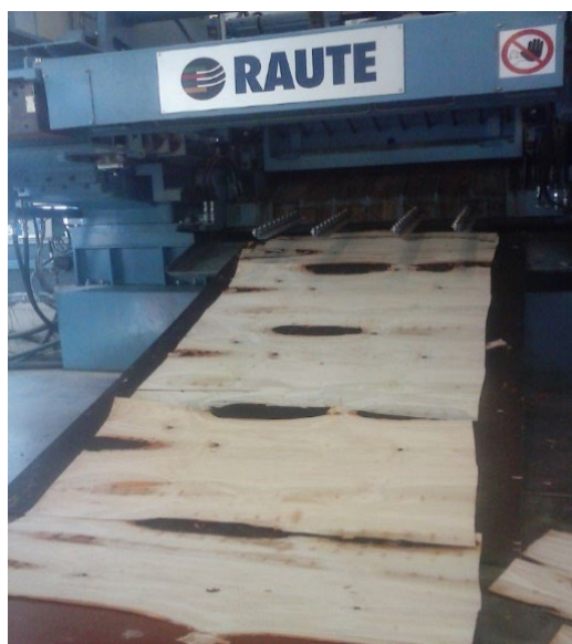
Joonis 5.46 Treimisel tekkiv ebaühtlane spoon.
