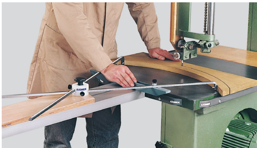
Joonis 4.8 Liikuva baseerimise näide, kõverpindade lõikamine lintsael rakise abil. Foto: firma Aigner kataloogist
