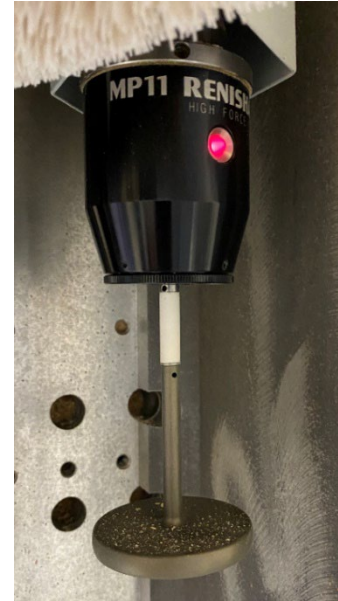
Joonis 7.44 Peamootori kõrval asuv mõõteandur.
