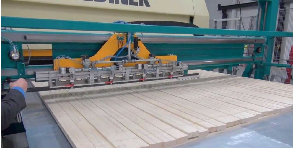
Joonis 5.10 Ristkihtliimpuidu tootmises kasutatav liimitamiseseade. Foto: Lappia Finland
