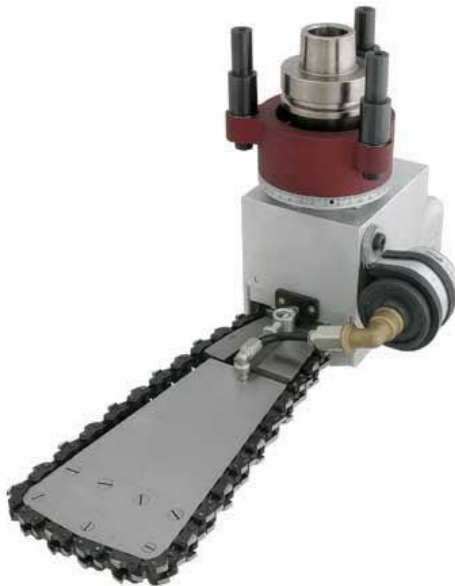
Joonis 7.22 Mootorsae-tüüpi agregaat suuremõõtmeliste tappide tootmiseks. Foto: Peak Toolworks
