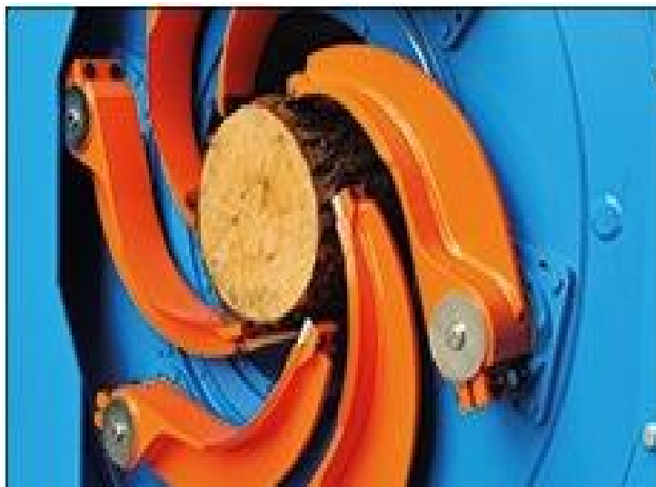
Joonis 2.11 Rootorkoorimisingi noad. Foto: Valon Kone OY
