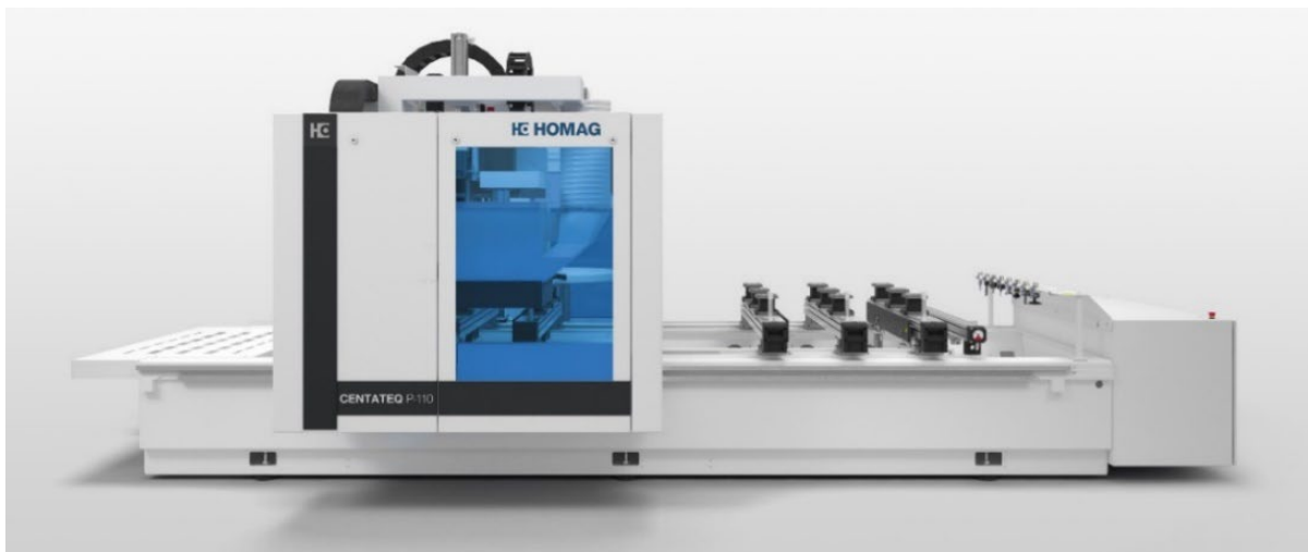
Joonis 7.27 3- või 4-teljeline CNC-töötlemiskeskus. Foto: HOMAG Group AG
