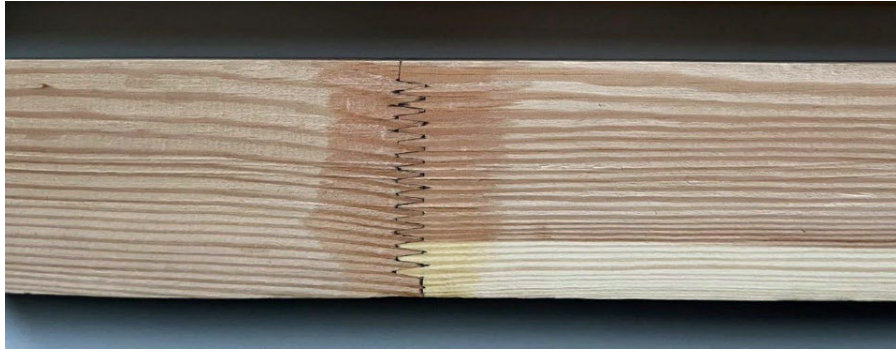
Joonis 4.31 Sõrmjätatud tooriku liimliite kontrollimine joodiga.
