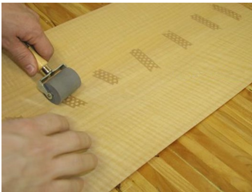
Joonis 6.29 Spooniribade ühendamine liimipaberi ribadega. Foto: JoeWoodworker.com
