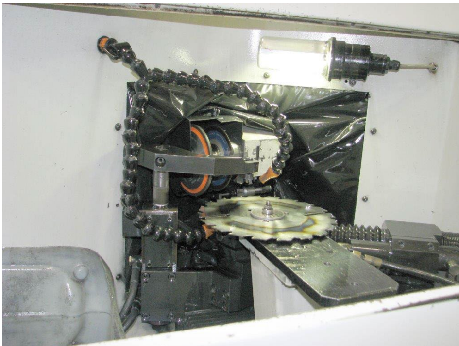
Joonis 1.33 Saeterituspink. Foto: M. Riistop
