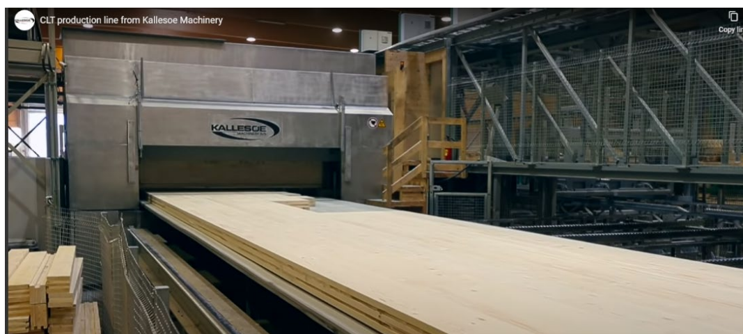
Joonis 10.60 Hasslacher Norica Timber ja kõrgsageduspressi tootja Kallesoe kulusäästlik ristkihtliimpuitpaneelide pressimisliin, kus avadesse puitu ei panda.
