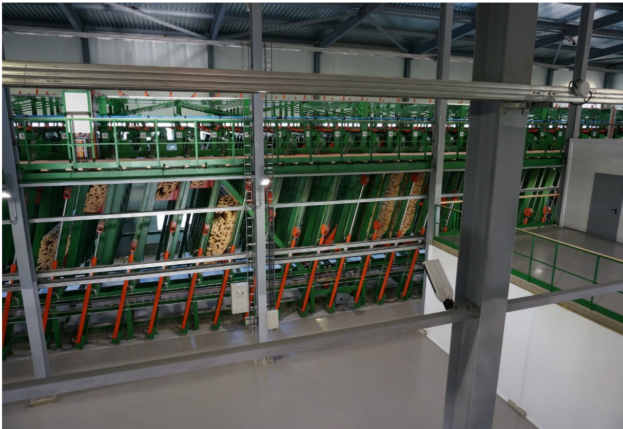
Joonis 2.25 Vertikaaltaskutega sortimisliin. Foto: AS Hekotek
