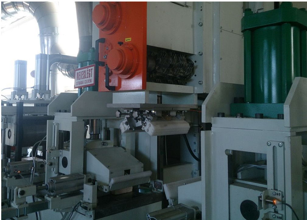
Joonis 4.23 Vertikaalsõrmtapi freesimis- ja liimitamise seade. Foto: J. Salla
