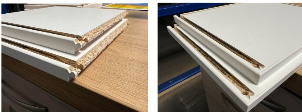
Joonis 9.85 Threespine® Core tehnoloogial toodetud kapidetailid. Fotod: TNC Components OÜ.
