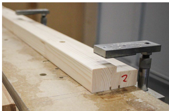
Joonis 7.47 Ukselengide fikseerimiseks kasutatakse suruõhuklambreid.
