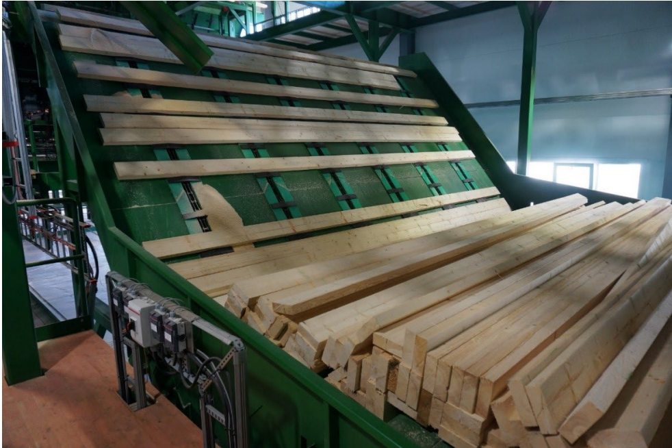
Joonis 2.27 Saematerjali ükshaaval välja andmine nukkidega kaldkettkonveieri abil. Foto: AS Hekotek
