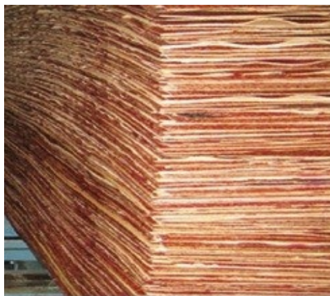
Joonis 5.70 Spoonid on laotatud vineeritoorikuks vastu külgsuunas. Allikas: Raute Oyj
