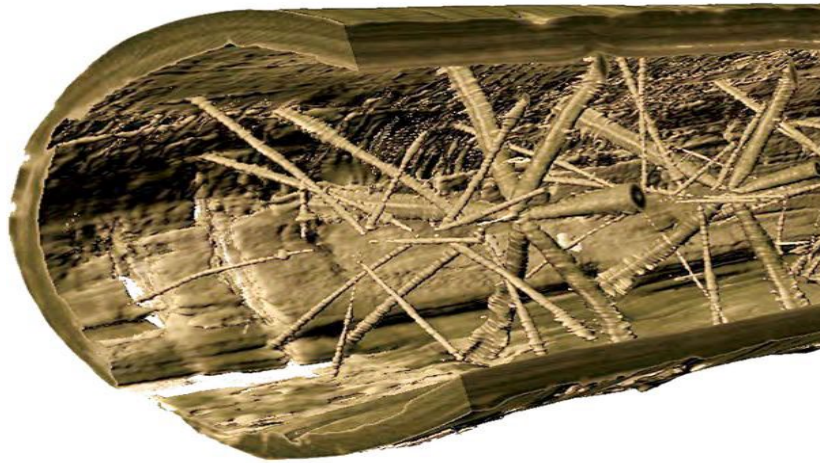
Joonis 2.5 Näide Palgiskanneri CT Log skaneeringust. Foto: Microtec Srl
