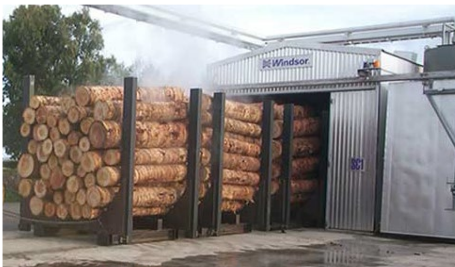
Joonis 2.60 Palgivankrid aurukambrisse. Foto: Windsor Engineering Group Ltd
