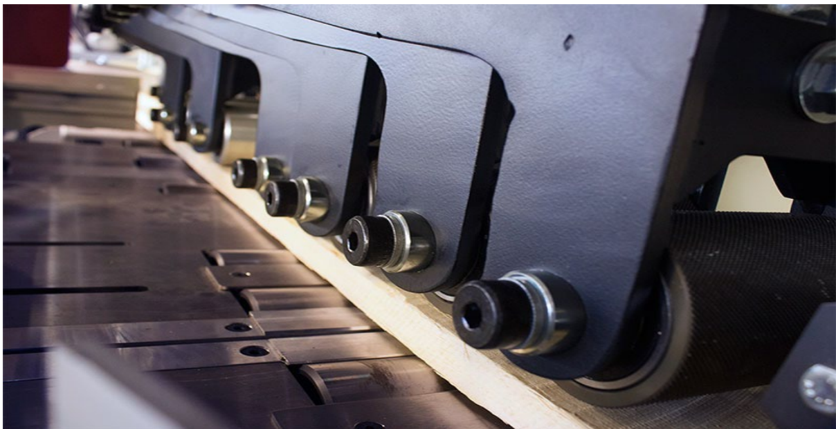
Joonis 4.28 Valtsetteandega optimeeriva järkamissae etteandevaltsid. Foto: System TM
