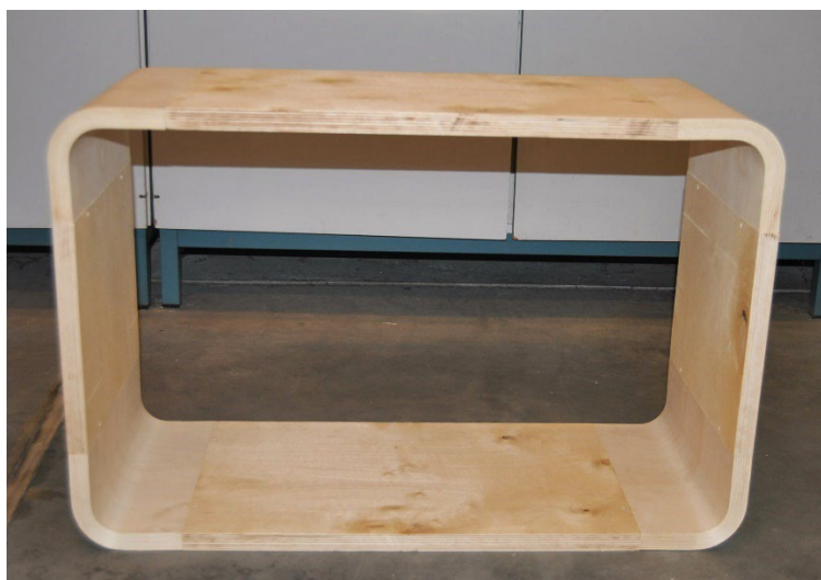
Joonis 9.28 Clamex 15 lamelltüüblitega koostatud riiul.
