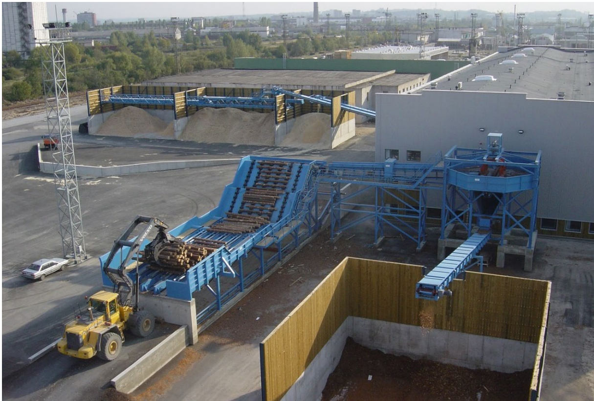
Joonis 2.7 Palkide saeliini etteandeseadmed. Foto: Hekotek AS
