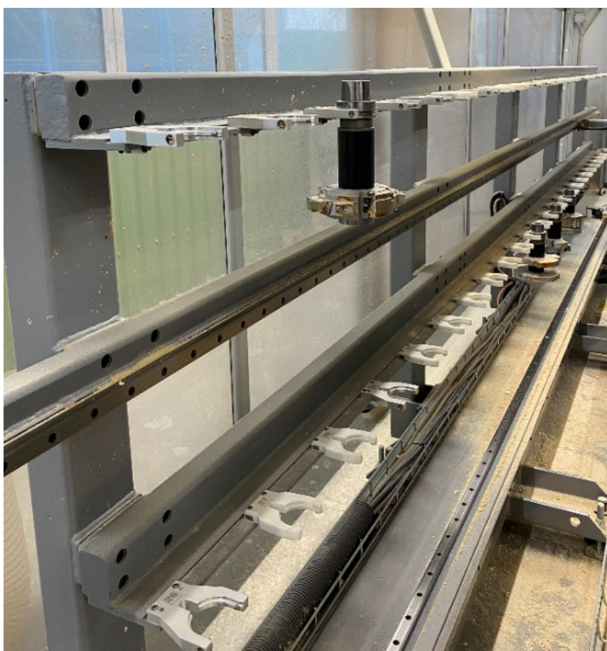
Joonis 7.57 Vaheladu viiekümnele instrumendile.
