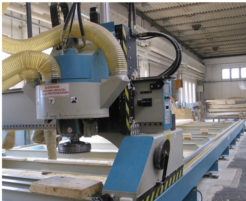
Joonis 1.51 Laupreesimismasin majatehases. Foto: M. Riistop
