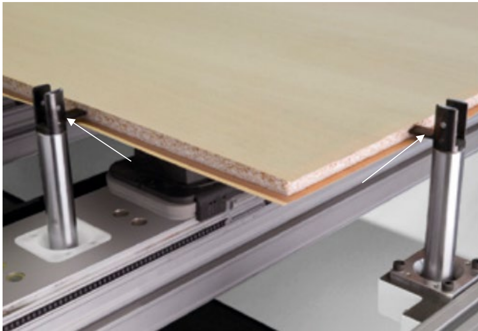
Joonis 7.41 Ärapöörduva plaadikestega nullpunktid plokkuste korral.
