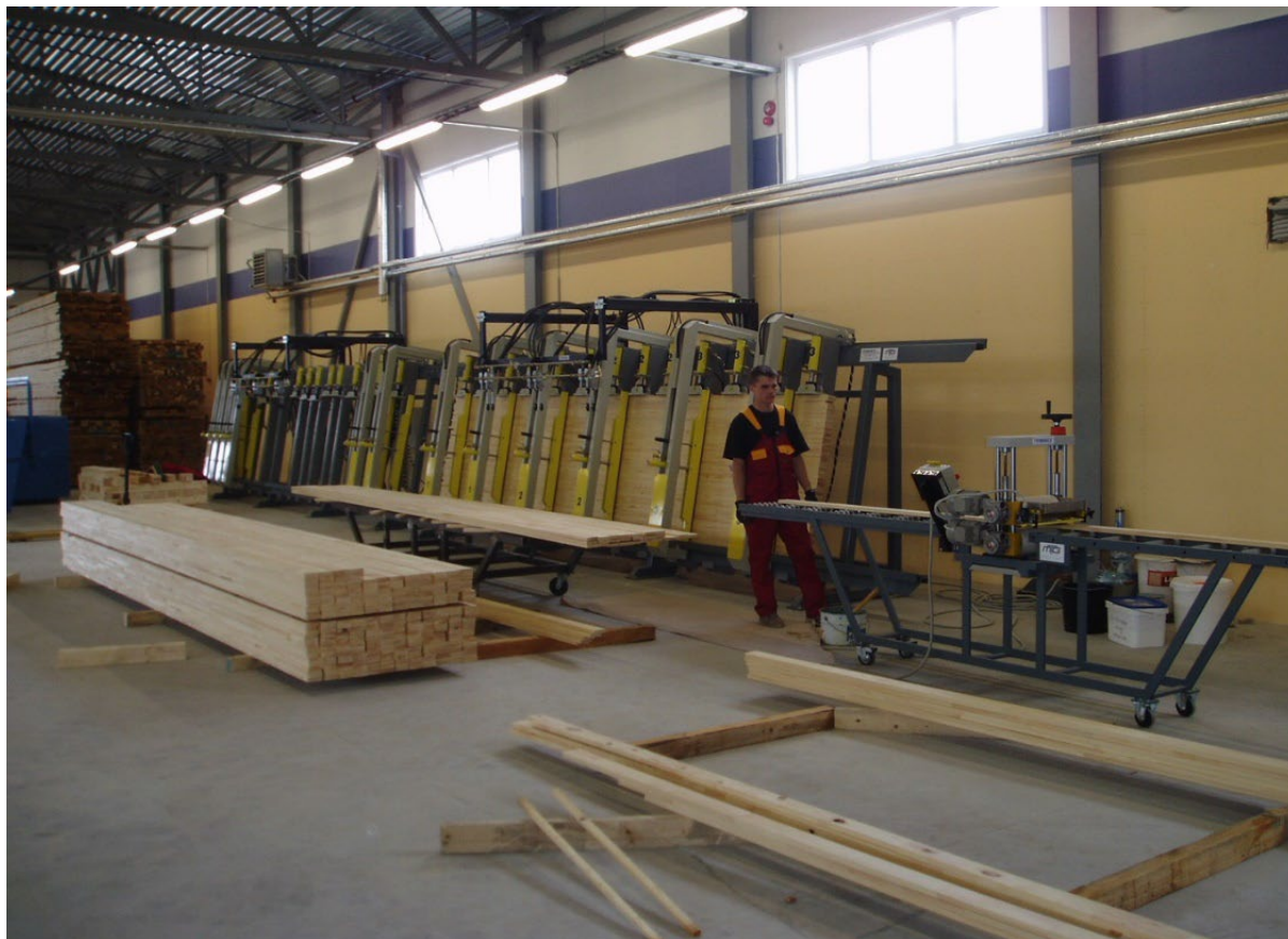
Joonis 5.8 Liimvaltsid (paremal) ja seinapress (vasakul). Foto: JS Inseneribüroo OÜ
