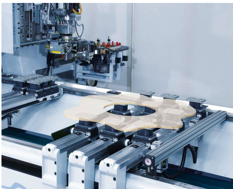
Joonis 7.12 Automaatpositsioneerimisega töölaud. Foto: HOMAG Group AG
