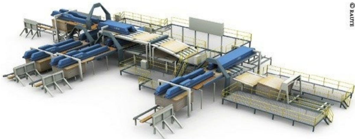
Joonis 5.72 Vineeritoorikute automaatkoosteliin. Allikas: Raute Oyj
