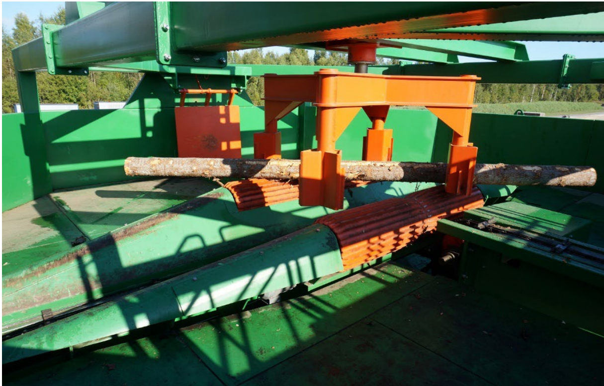
Joonis 2.8 Seade palkide pööramiseks ladvaga eespool. Foto: Hekotek AS
