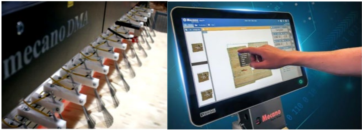
Joonis 3.45 Spooni niiskuse automaatkontrollisüsteem. Allikas: Raute Oyj
