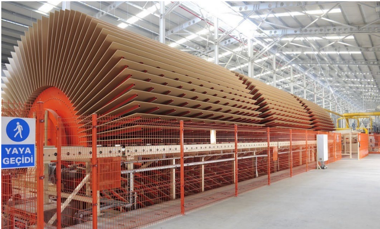
Joonis 5.99 Plaatide jahutus pärast kuumpressimist. Foto: G. Siempelkamp GmbH & Co. KG
