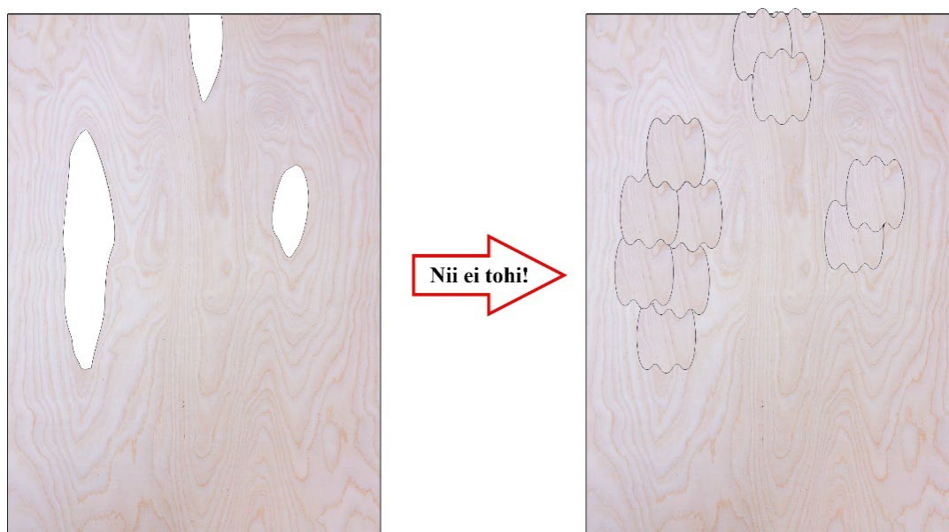
Joonis 5.61 Spoonipaikade vale paigutus.
