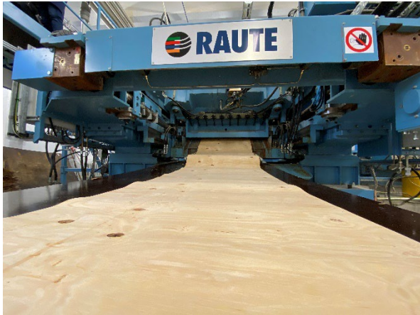
Joonis 2.73 Spoonitreipingist spoonimati väljatulek.
