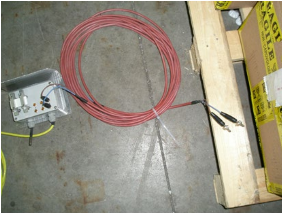
Joonis 3.18 Kuivati anduriplokk. Foto: JS Inseneribüroo OÜ
