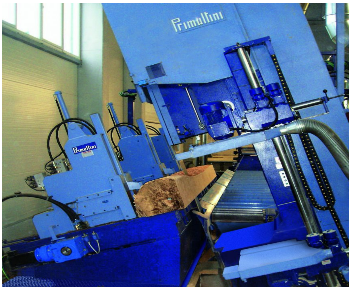
Joonis 2.49 Saagimine vertikaalsest asendist kallutatud saega (tagab selle, et kõik saetud laud langevad konveierile ühtepidi). Foto: Primultini s.r.l.
