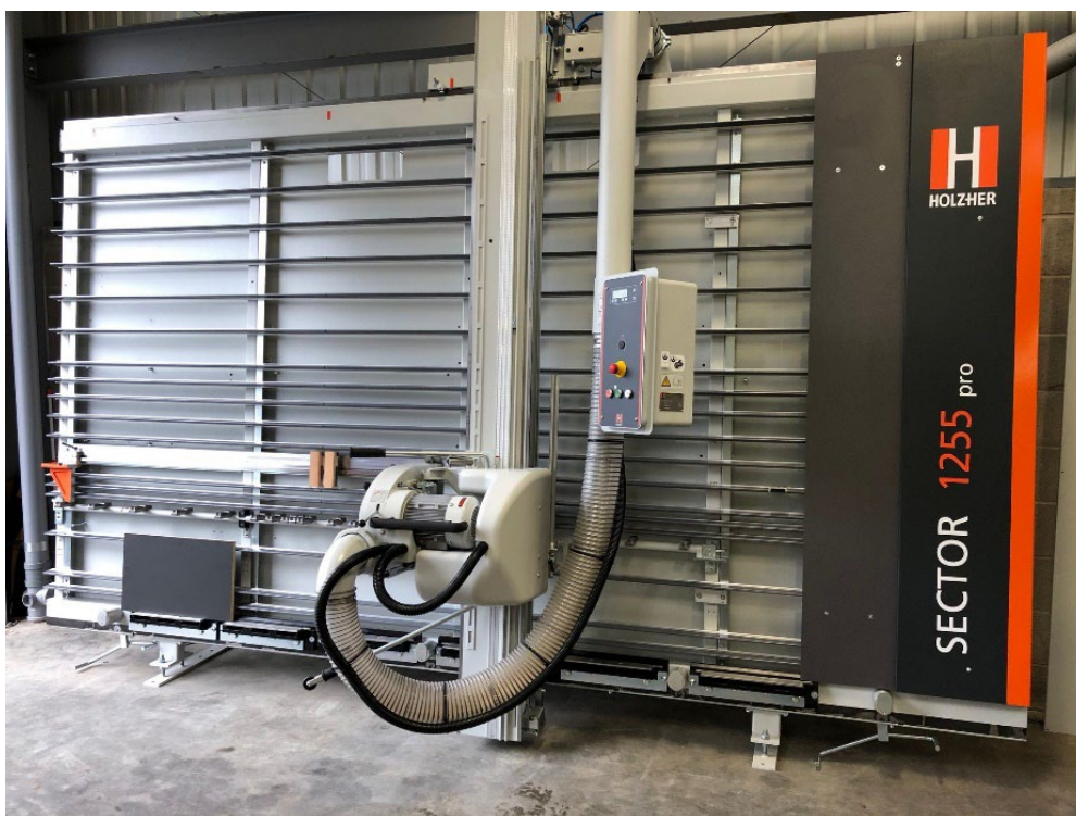
Joonis 6.2 Vertikaalformaatsaag. Foto: HOLZ- HER GmbH
