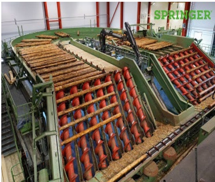
Joonis 2.9 Palkide etteanne spiraalrullidega poolringkonveierile ladva ette pööramiseks (õigetpidi liikuvaid palke poolringkonveierile ei suunata). Foto: Springer Maschinenfabrik AG
