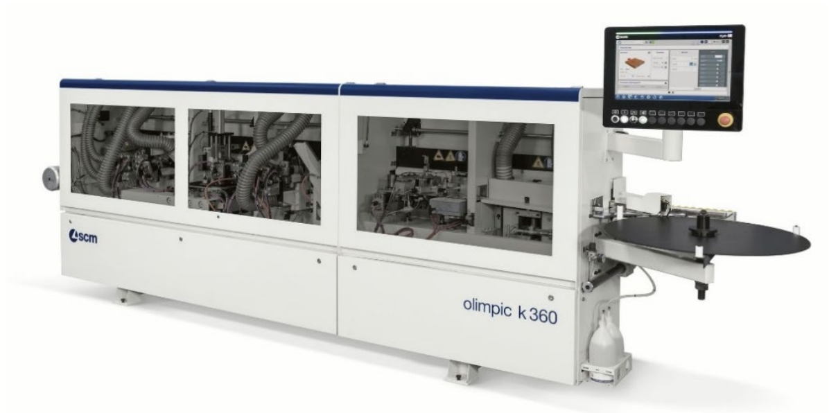
Joonis 6.12 Servapealistusmasin. Foto: SCM Group
