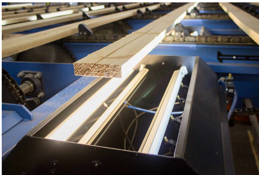
Joonis 2.23 Boardmaster Nova- SL saelaua kvaliteedi hindamine alumiselt küljelt masinsortimisel. Foto FinScan OY
