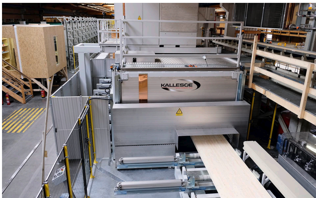
Joonis 5.21 Kõrgsageduspress. Foto: JS Inseneribüroo OÜ
