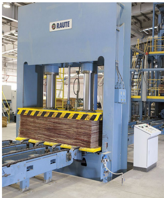
Joonis 5.74 Vineeritoorikute eelpressimine. Allikas: Raute Oyj
