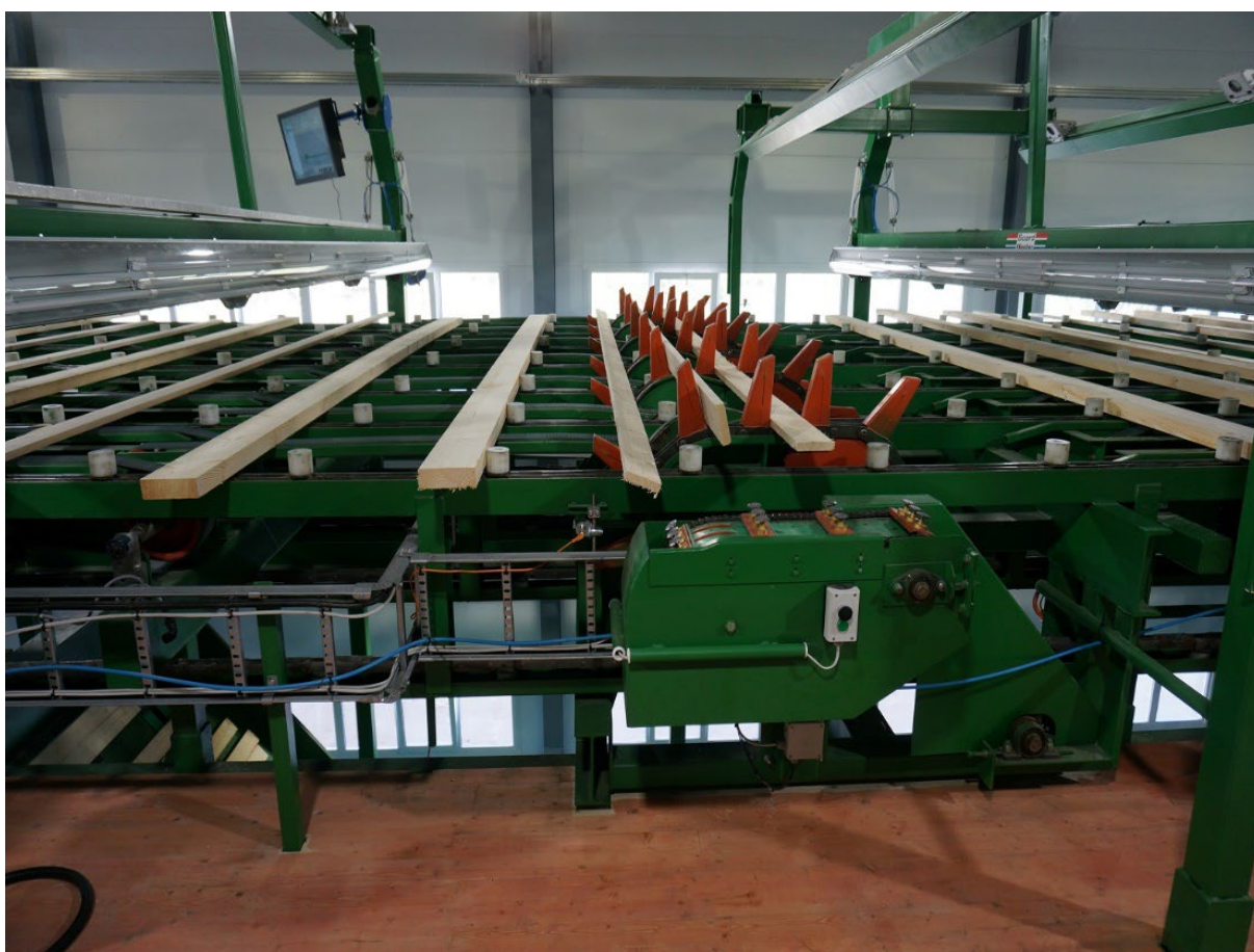
Joonis 2.21 Kaamerad saematerjali hindamiseks sortimisel, vasakpoolne kaamera hindab üht külge, materjal pööratakse teistpidi ja parempoolne hindab teist külge). Foto: AS Hekotek
