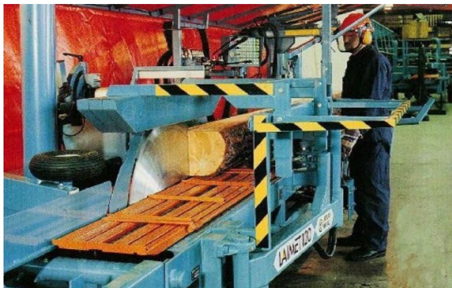
Joonis 2.41 Ühekettaline palgisaag. Foto: exapro.com
