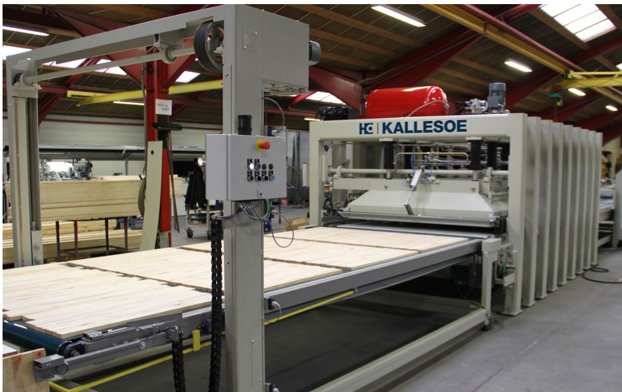
Joonis 5.19 Kuumpress liimpuitkilpide tootmiseks. Foto: JS Inseneribüroo OÜ
