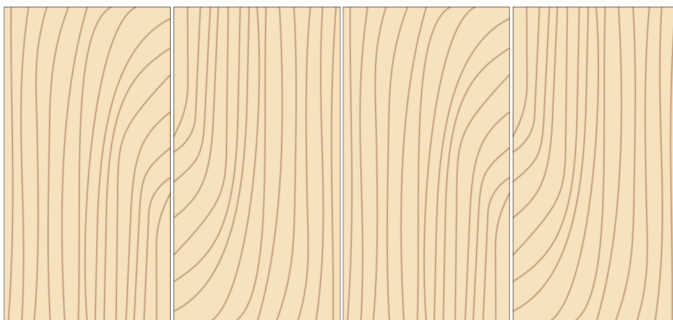
Joonis 6.33 Spooni pööratud-järjestikliide. Joonis: doogeveneers.com
