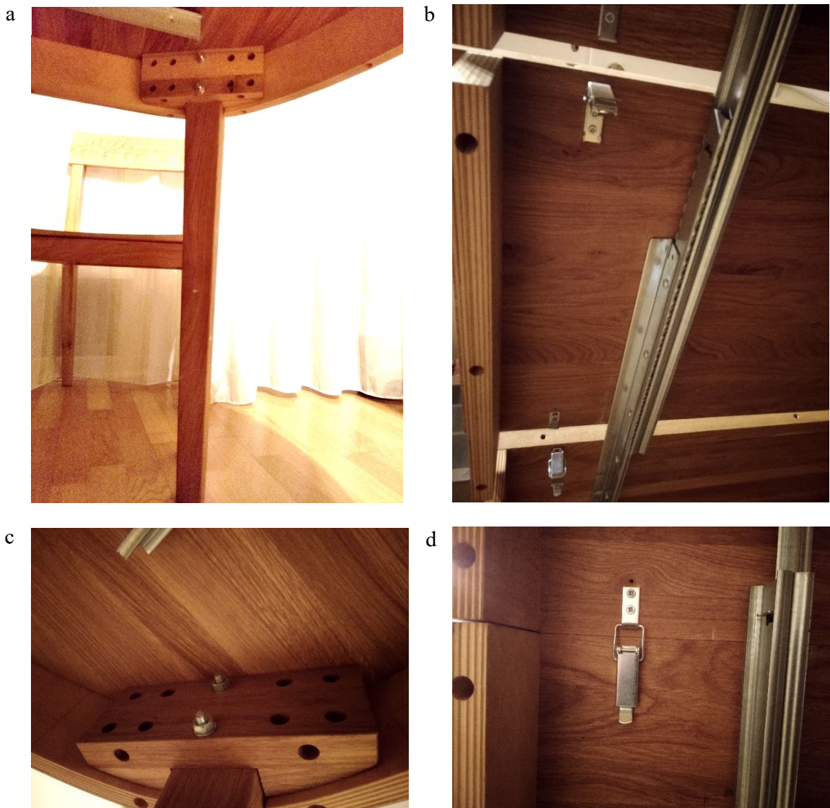
Joonis 9.84 Pikendatav söögilaud siinide ja kinnitusklambritega: a – lauajalg, c – lauajala kinnitus tikkpoltide, mutrite ja puidukruvidega, b – siinid söögilaua pikendamiseks ja d – plaate ühendav kinnitusklamber.
