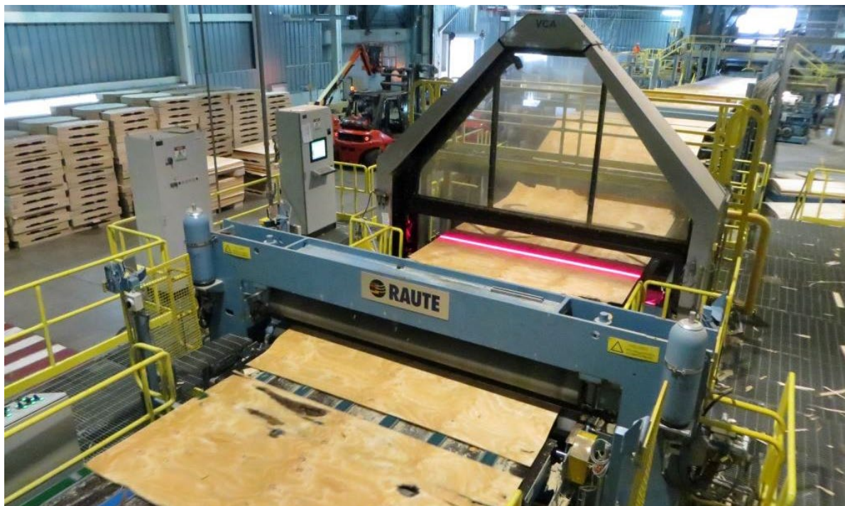
Joonis 5.43 Spooni vigade identifitseerimine skanneriga. Allikas: Raute Oyj
