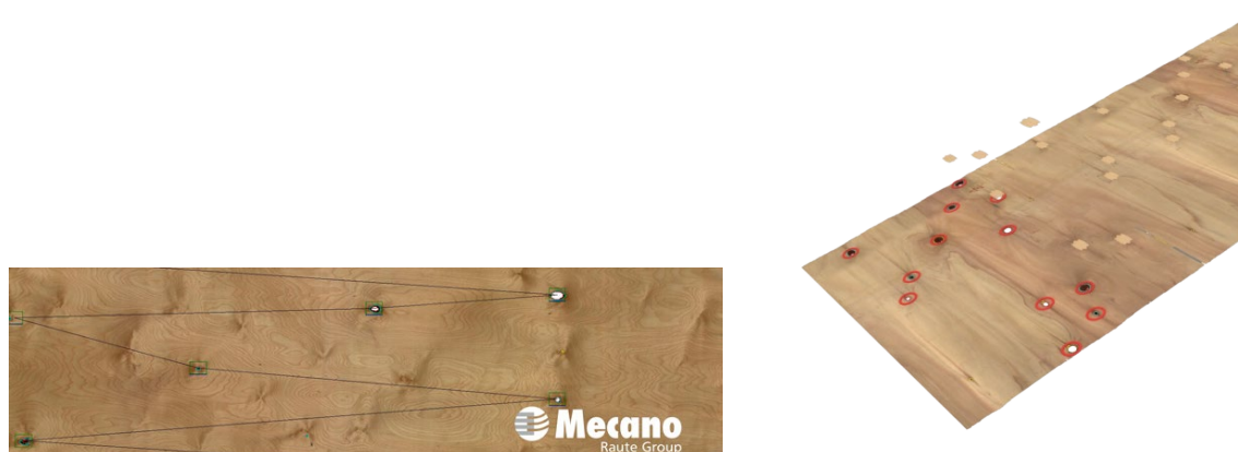
Joonis 5.55 Spoonidefektide tuvastamine Raute Oyj VDA masinnägemise süsteemi poolt. Allikas: Raute Oyj
