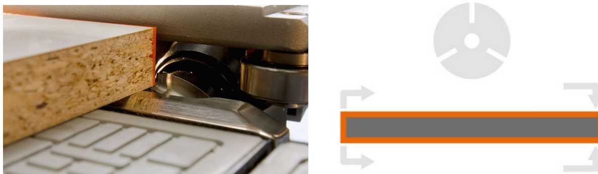
Joonis 6.19 Korduvtöötlusagregaadi frees ja selle liikumine. Foto: HOLZ-HER GmbH
